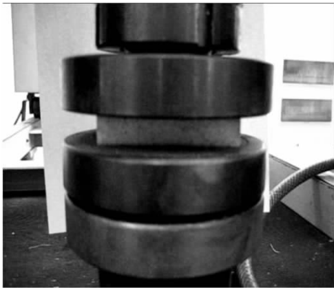
图 2 X-Cor 夹层结构平面压缩试验
